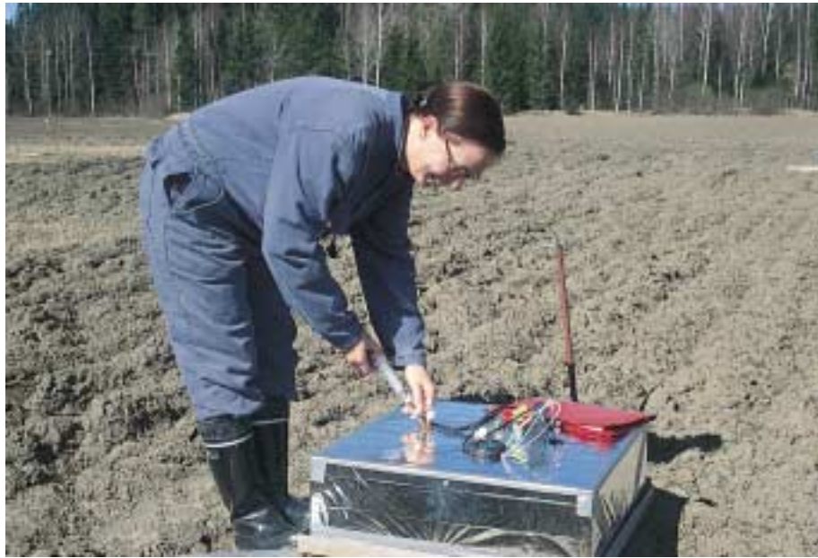
Kuva 6–3 Maa- ja elintarviketalouden tutkimuskeskuksen FIGARE-mittausasema Jokioisissa. Metaani- ja dityppioksidipäästöjä seurattiin ympäri vuoden jaksolla 2000–2002.
